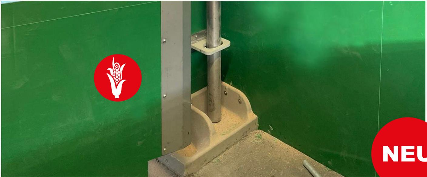
NEU sind unsere beiden Futterautomaten mit Rüttelrohr (MuKimat und RüRomat) auch als Variante für CCM sowie Ganzpflanzenmais-Fütterung (GPM) erhältlich. Der Durchmesser des Rüttelrohrs wurde überarbeitet und angepasst.
